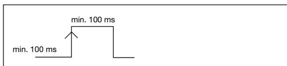
Zum Wiedereinschalten (Reset) benötigt ein ausgeschalteter ESX10-(S)125 einen Impuls mit einer Dauer von mindestens 100 ms. Der ESX10-(S)125 kann nicht explizit ausgeschaltet werden.
